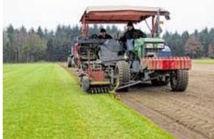
Eine Schälmaschine schneidet den Rasen in 40 Zentimeter breite Stücke ab
